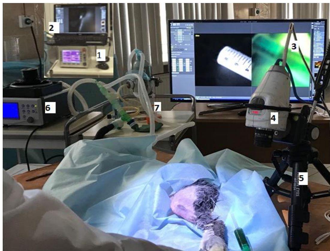
Рисунок 9 – Система «FLUM-808» при проведении лимфографических исследований в эксперименте на кролике: 1 – лазерный аппарат «Лахта-Милон 808/9»; 2 – ноутбук; 3 – световод; 4 – ТВ-камера «ICG-Skope»; 5 – штатив; 6 – аппарат искусственной вентиляции легких; 7 – испаритель «МИНИВАП 20/1»
