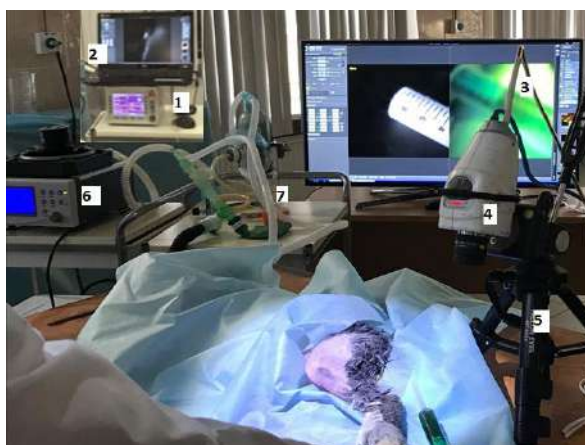
Рисунок 1 – Система FLUM-808 при проведении лимфографических исследований в эксперименте на кролике: 1 – лазерный аппарат «Лакхта-Милон 808/9»; 2 – ноутбук; 3 – световод; 4 – ТВ-камера «ICG-Skope»; 5 – штатив; 6 – аппарат искусственной вентиляции легких; 7 – испаритель «МИНИВАП 20/1»
